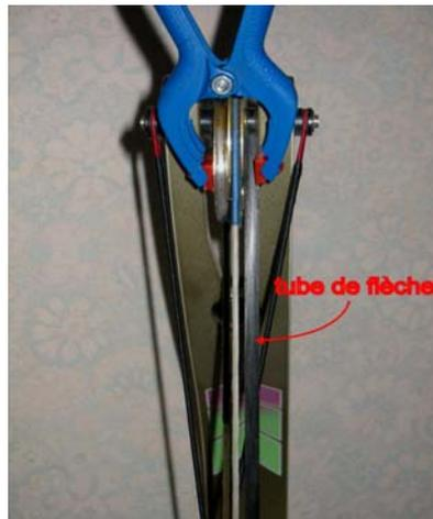
En posant une règle sur la surface de la poulie, on matérialise un plan parallèle au plan de la gorge des poulies. Il est alors facile de visualiser si ce plan est parallèle à la corde ou pas (voir photos).
