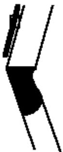
C'est une simple réglette graduée qui est fixée directement sur le bord extérieur de la fenêtre d'arc, il est le viseur d'initiation par excellence.
